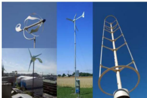
Exempel på små vindkraftverk. Överst till vänster Enegy ball 500 W, 1,1 m diam. Nedan Airdolphin/Egen El 1000 W, 1,8 m diam. Mitten Winddon 2 kW, 3,2 m diam 9 m mast. Höger Windspire 1,2 kW, 2,4 m diam, 9 m hög
