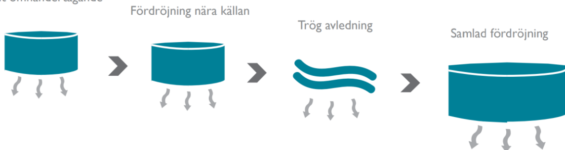
Figur 7. Illustration av kategorier för öppna dagvattenlösningar.
